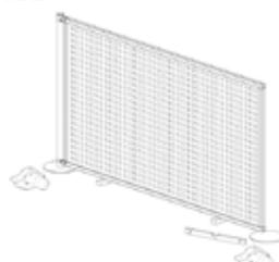
**Paso 6)** Si se opta por el anclaje con placa base en lugar de cimentación, atornillar la base e insertar el primer poste. Enganchar el panel y colocar el siguiente poste.
