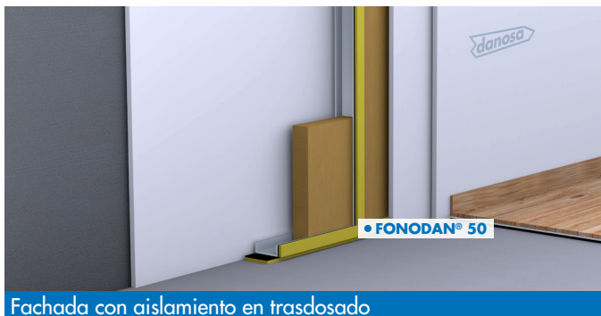
Fachada con aislamiento en trasdosado
