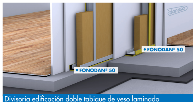
Divisoria edificación doble tabique de yeso laminado
